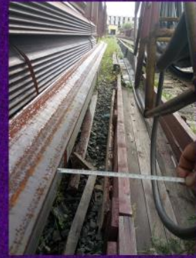
Нарушение габаритов складирования
