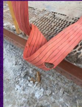
Использование неисправных стропов
